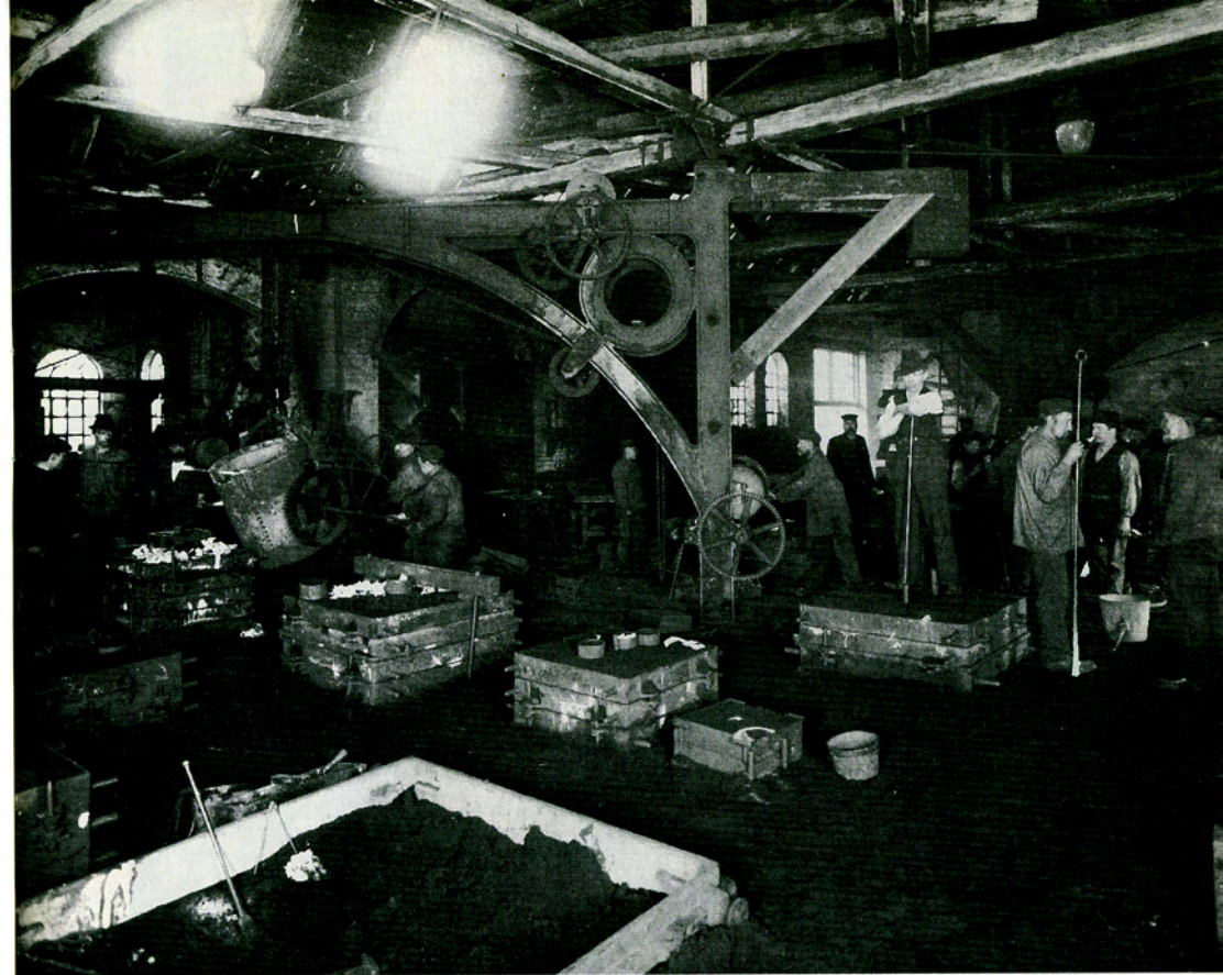
Frichs støberier i Århus omkring 1900 (Erhvervsarkivet). Fotografiet viser et stort støberi med spil til diglen med det flydende jern og mange kasser til støbning af maskindele. Fotografen har villet afbilde en handlingssituation, men belysningsforholdene har tvunget ham til at lade personerne stå helt stille under eksponeringen. Derfor den tableauagtige virkning. Arbejdsmiljøet fremtræder dog både realistisk og med autenticitet.
